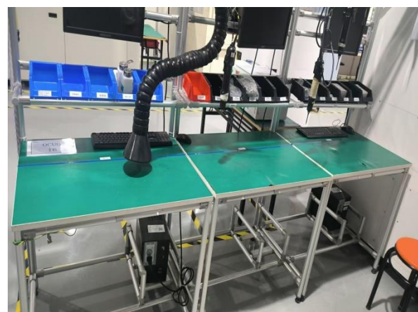
废气收集集气罩
